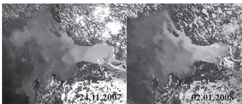
Рис. 3. Слева — КС MODIS за 24.11.2007. Начало процесса льдообразования. Дноуглубительные работы не проводятся. Повышенные значения концентраций взвеси отмечаются на значительной части акватории. Справа — КС MODIS за 02.01.2008. Даже после прекращения гидротехнических работ тонкодисперсная пелитовая составляющая взвеси еще долгое время (до 1,5–2 месяцев) находятся во взвешенном состоянии
