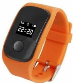
Прибор оповещения детей представляет из себя прибор выполненный в виде часов во влагозащищенном исполнении, имеет встроенный GPS трекер, модуль связи с контрольным прибором осужденного, модуль связи с системой (GSM модуль), средства аудио- и видео- регистрации и оснащен тревожной кнопкой.
